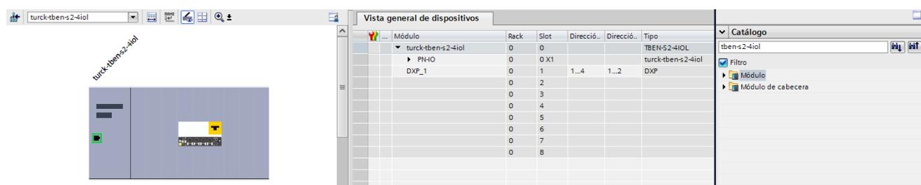
Desplegaremos la carpeta “Módulo” del catálogo de Hardware para añadir los tres elementos básicos de diagnósticos y la configuración del puerto.
