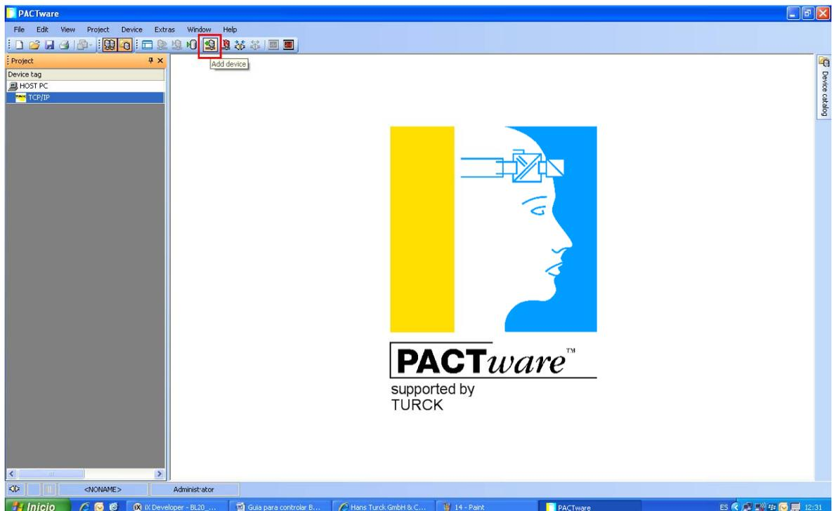
Al clicar sobre add device, se abrirá una pantalla donde se tiene que escoger el tipo de módulo externo a configurar, en este caso es el BL20-E-GW-EN. Clic en OK.
