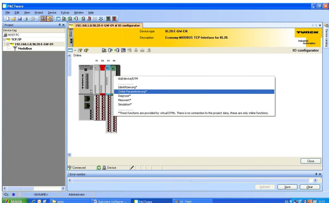
Ahora solo falta configurar la señal del módulo de salidas analógicas como se desee. Se puede cambiar el tipo de señal que se quiera (4-20mA, 0-20mA, 0-10Vdc,...), la representación del valor en bits, diagnostico,...
