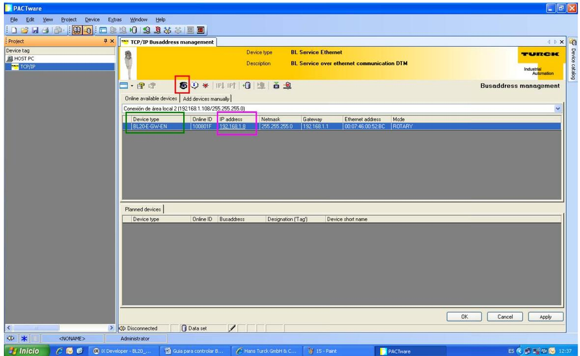
Una vez que se conozcan los módulos conectados y sus direcciones IP correspondientes, hacer clic sobre la opción add device (recuadro rojo) para añadir el módulo que se quiere configurar.
