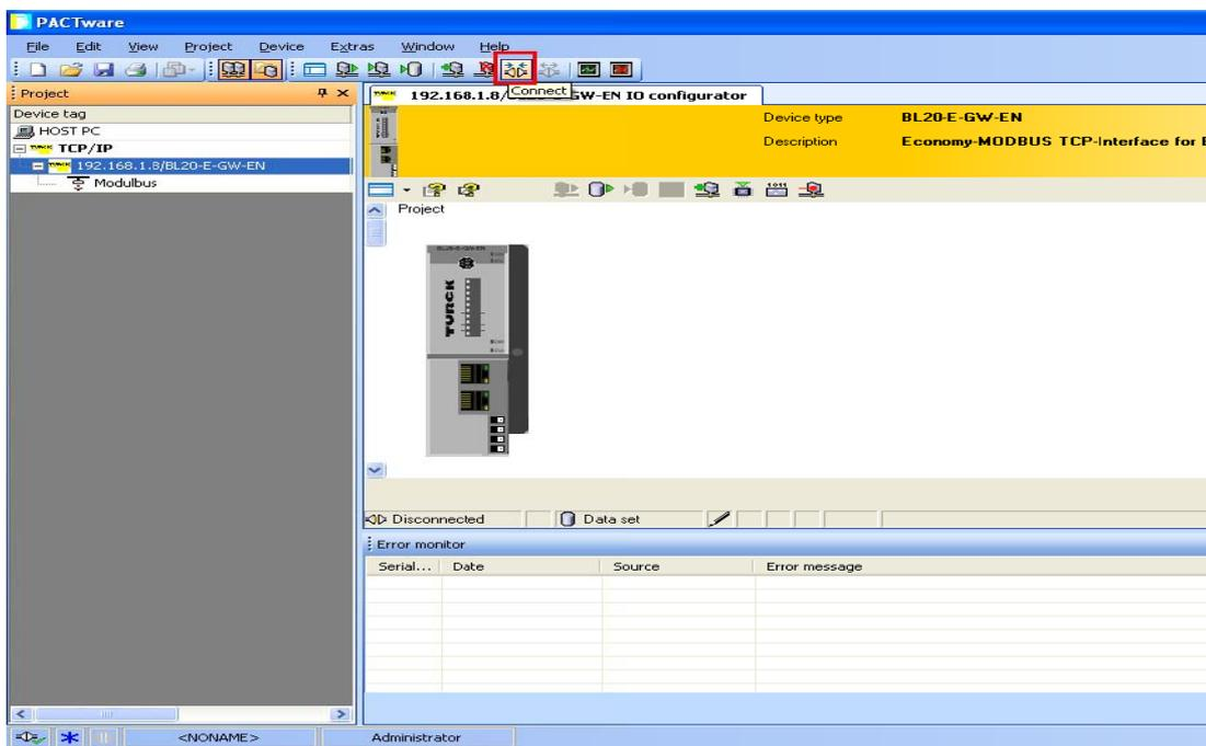
En este ejemplo se utilizará el segundo método, una vez clicado sobre **connect** automáticamente el software PACTware detectará que módulos de entradas y salidas (recuadro rojo) se tiene conectado con en el BL20 y los mostrará en el dibujo de la pantalla.
