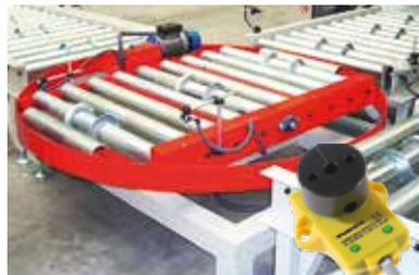
Control de posición (0°-360°) de plataforma giratoria a través de sensor de ángulo con doble salida analógica o SSI.
