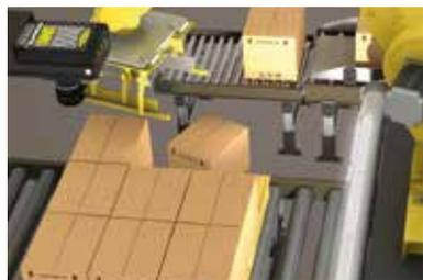
Posicionamiento y alineación en la formación de palets mediante sensor de visión.
