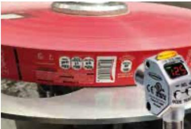
Medición precisa del diámetro de bobina de etiquetas con sensor fotoeléctrico réflex láser. El color de las etiquetas será indiferente, es la solución idónea ante bobinas de distintos colores y formatos.
