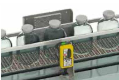
Detección de objetos extraños en el interior de recipientes mediante sensores de visión.
