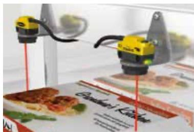
Detección de material reflectante con láser Q4X, para un correcto contaje y empaquetado.
