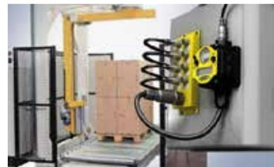
Medida de distancia con independencia del color del objeto a medir mediante láser.
