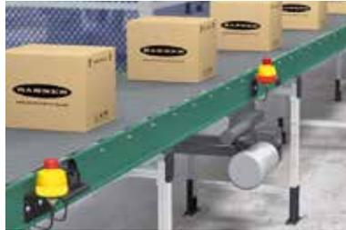
Alineaciones sencillas de objetos gracias al haz de luz roja visible LED o láser visible.
