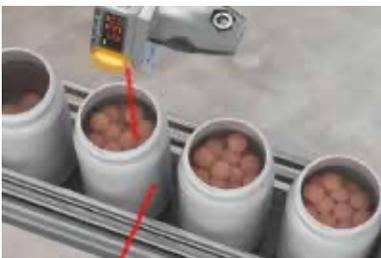
Detección de bandejas transparentes con sensor de muy bajo umbral.
